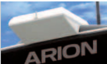
Der Omnistar HP Empfänger für GPS-Signal und GPS-Referenzsignal.
