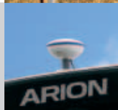
Der Omnistar HP Empfänger für GPS-Signal und GPS-Referenzsignal.
