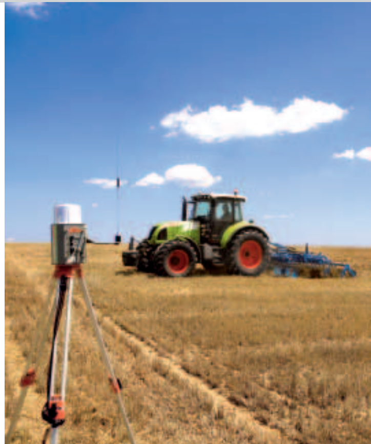
Der GPS-Empfänger des Baseline HD Systems. Dazu gehört ein zusätzlicher Funk-Empfänger für das Referenzsignal.
